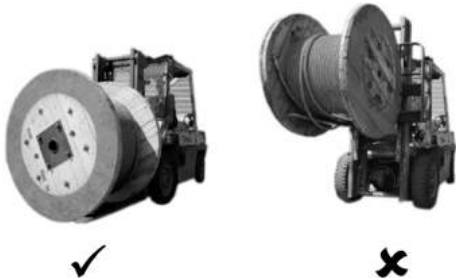
Fig. 439: Elevar el devanador del cable de forma correcta con una carretilla elevadora (izquierda) y de forma incorrecta (derecha)
