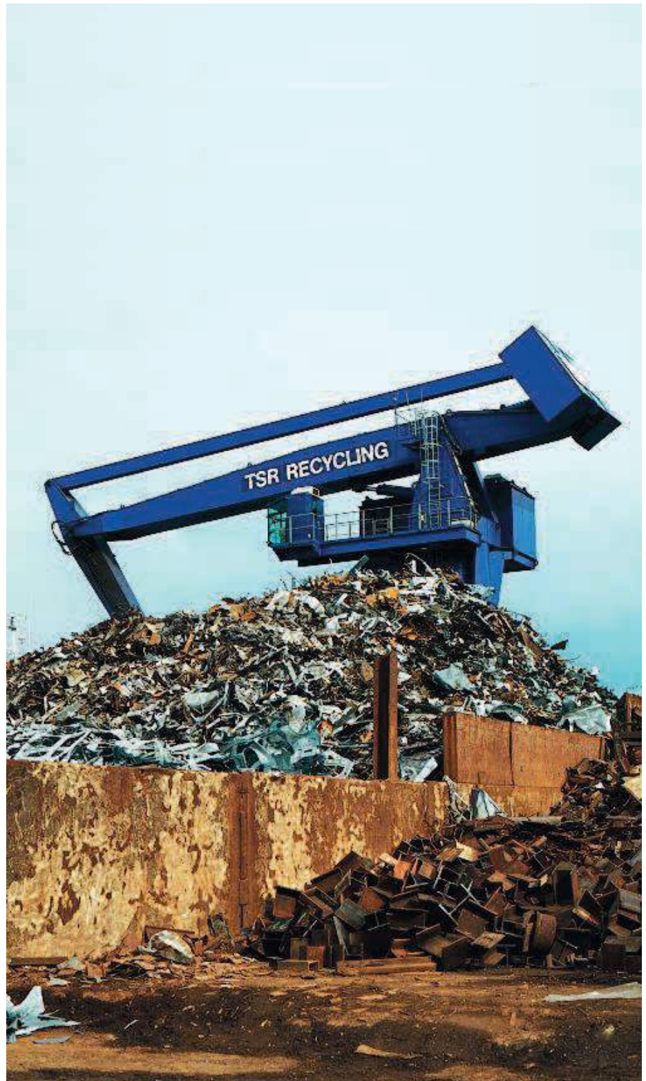
Das ausbalancierte vierteilige Auslegersystem des Pelikans
