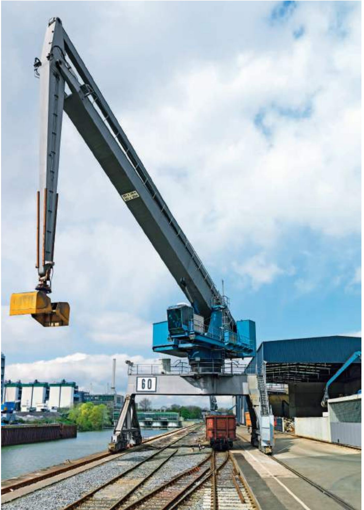
↑ Der Pelikan mit Hochportal auf Schienenfahrwerk
