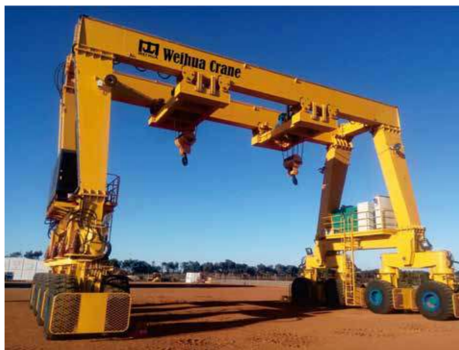
出口澳大利亚轮胎式集装箱门式起重机 Rubber Tire Container Gantry Crane Exported to Australia
